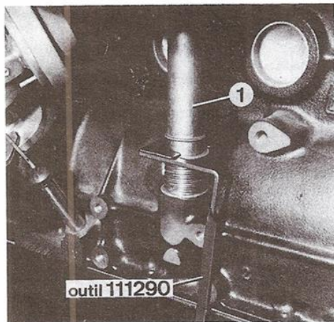
Mise en place de l'outil 111290 d'immobilisation du tube de reniflard. 1. Tube de reniflard.
